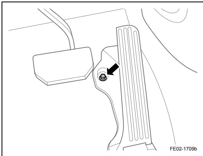
3. 拆卸电子油门踏板。
