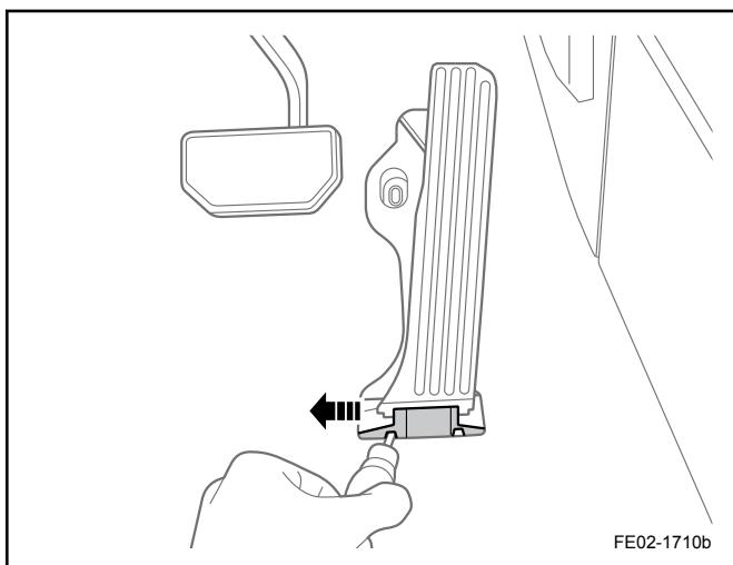
4. 断开电子油门踏板线束连接器。
